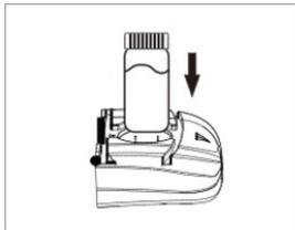
3. Ponga la botella colorimétrica en el tanque colorimétrico.
